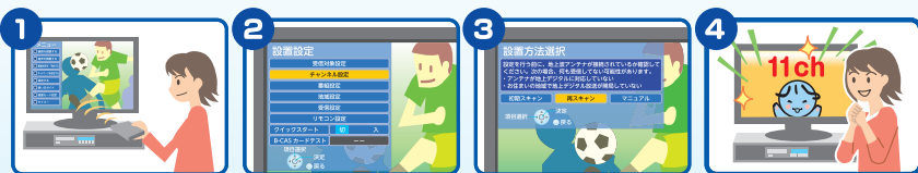
1 テレビのメニュー画面を表示させる。 2 設定画面にてチャンネル設定を行う。 3 地上デジタル放送を再スキャン。(チャンネル再設定操作) 4 テレビのリモコンボタンの「11」が映るか確認する。
